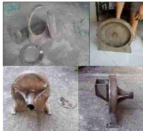
Gambar 3. Pemotongan material dan Perakitan diskmill
