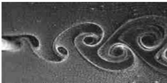
Gambar 2: Bentuk aliran vortex
