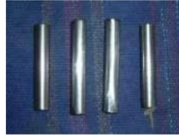
Gambar 7. spesimen uji kekerasan
