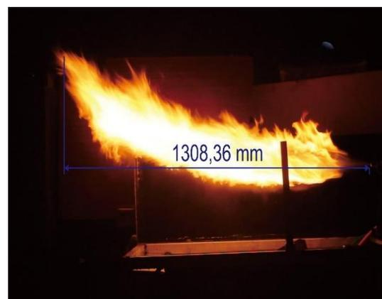
Gambar . Pengukuran panjang nyala api
