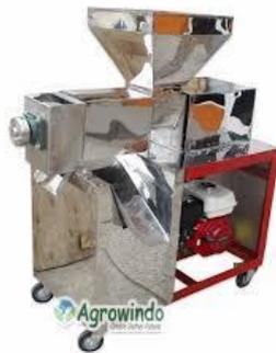
Gambar 2 mesin pemeras santan sistem *screw press*[4]
