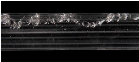
Gambar 6. Pola aliran pada debit 20 l/menit dikondisi udara 2.5 l/menit groove 0 dan 16.
