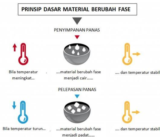
Gambar 1. Prinsip dasar material berubah fase
